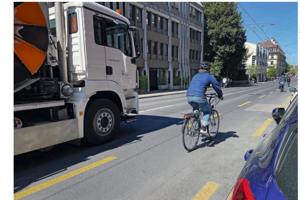
Autor und Testfahrer Edward Weber auf einer Messfahrt in der Berner Länggasse. Ein Sensor am Velo misst, mit welchem Abstand der Lastwagen überholt.
